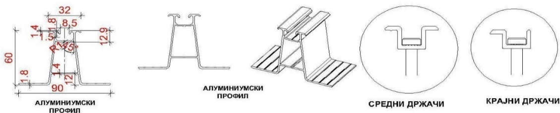
Слика 7. Изглед на основната алуминиумска потконструкција
